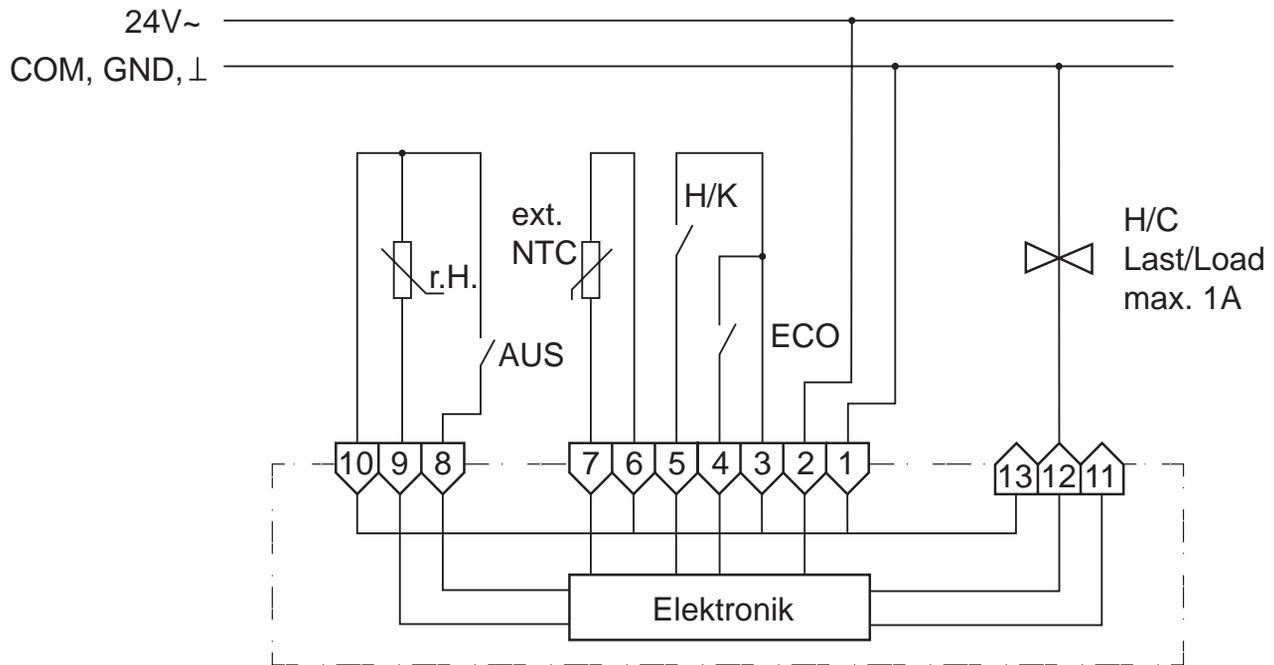
Anschluss im 4 Rohrleitungssystem:
