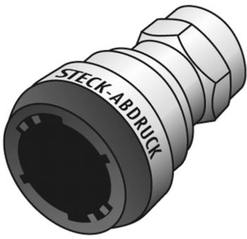
Steck-Abdruck-Übergang mit Innengewinde aus Edelstahl 1.4401, inkl. EPDM-Dichtelemente und Auszugsbarrieren, demontierbar, zum Abdrücken der Steelfix- und Kupferrohre
