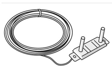
Zum Messen und Fühlen des Taupunktes bei Kühldeckenanlagen, die Montage erfolgt in der Kühldecke am Mediumrohr, die Schnüffelrohre werden nach der Montage der Decke abgeschnitten und messen die Luftfeuchte, inkl. 10m Kabel (2x0,5mm<sup>2</sup>) und Befestigungsmaterial zur Befestigung am Rohr.
