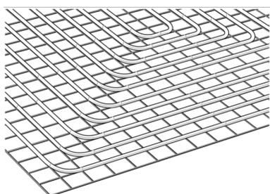
COOLFIX Deckenkühl- u. Heizmodul inkl. KELOX-ULTRAX Verbundrohren d16x2mm, sauerstoffdicht gemäß DIN EN 21003, werkseitig vormontiert auf verzinkten Baustahlgittermatten
