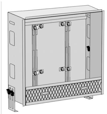
Sendzimerverzinkter Universal-Stahlblechschrank, Anschlussmöglichkeit von unten oder seitlich, höhenverstellbare Füßen, nachrüstbar mit einem AP-oder UP-Sichtteil. Zum Einbau vom KM651 KELOX FB Festwertregel-Set geeignet. Platz für Anschlussgarnituren KM593E gerade oder 90°, sowie KM591E Winkel 90° ist berücksichtigt. Anzahl der Verteilerabgänge auf KM590E und KMP590M KELOX FB Verteiler Messing abgestimmt!
