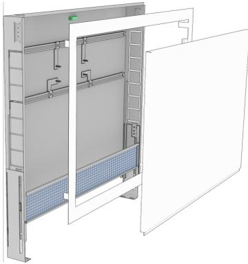
Verzinkter Universal-Stahlblechschrank (1mm), Anschlussmöglichkeit von unten oder seitlich, höhenverstellbare FüÙe mit Sonderlänge bis 32cm Bodenaufbau, Putzblende unterhalb vom Schrank, inkl. an der Putzblende vorstehendem Verputznetz und Verputzschutz für die Schrankinnenseite, inkl. Verteilerhalterungen, verzinkte, absperrbare Fronttüre und Rahmen, pulverbeschichtet.
