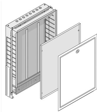
Verzinkter Universal-Stahlblechschrank mit teleskopisch ausziehbarem Rahmen, Anschlussmöglichkeit von unten oder seitlich, höhenverstellbare Füßen, Putzblende unterhalb vom Schrank, inkl. an der Putzblende 60mm vorstehendem Verputznetz und Verputzschutz für die Schrankinnenseite, inkl. Verteilerhalterungen, verzinkte, absperrbare Fronttüre und Rahmen, pulverbeschichtet, nachrüstbar mit Zylinderschloss.
