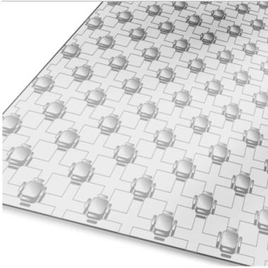
Tiefgezogene Rohrhaltenoppen zur stabilen Befestigung der KELOX-Modulrohre d16, Verbindung der einzelnen Platten durch Überlappung. Ein Längs- und ein Breitrand als verkleinerte Vaternoppe ausgeführt, gekennzeichnet mit dem KELIT - Logo zwischen den Vaternoppen, die Montage sollte Vorzugsweise an der rechten Seite eines Raumes begonnen werden. Als Ersatz für Klemmschiene, PE-Rasterfolie und Fixierhaken
