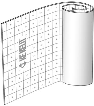
Extrudierter PE-Schaumstoff geschlossenzellig 100% HFCKW- und HFKW-frei vollflächig selbstklebend mit aufkaschiertem Velour-Gewebe, zum Fixieren der KELOX-ULTRAX FB Klettrohre und ULTRA PE-RT Klettrohre ohne zusätzliche Befestigung.
