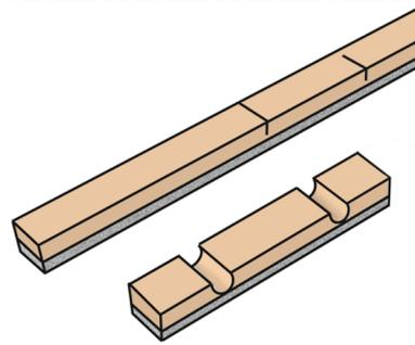
Rahmenholz umlaufend lose verlegt, zur Verbesserung der Druckfestigkeit des Bodens. Um bei Belagswechsel die nötige Stabilität bieten zu können, und damit die Oberprofilschiene befestigt werden kann, muss bei Türdurchgängen das Rahmenholz festgeschraubt werden.
