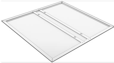
Sendzimerverzinkt, pulverbeschichtet, rahmenlos ohne sichtbare Befestigungspunkte durch vier bzw. sechs Magnethalter zur direkten Montage am Korpus, dreidimensional justierbar, umlaufende Aufkantung, vier Sicherungsseile mittels Schnellverschluss
