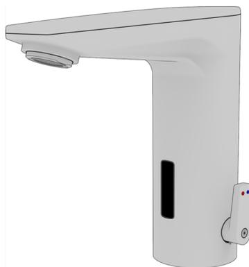
Berührungslose, elektronisch gesteuerte Einloch-Waschtischarmatur, Hochdruck, mit IR-Sensor, Hygienespülprogramm und Mischer mit einstellbarer Temperaturbegrenzung, Oberfläche verchromt, Betriebsdruck: 0,3 - 10 bar - max. 80°C. OHNE Stromversorgung
