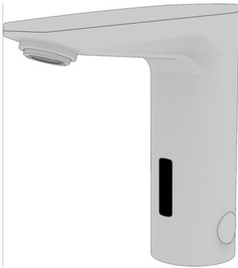
Berührungslose, elektronisch gesteuerte Einloch-Waschtischarmatur, Hochdruck, mit IR-Sensor, Hygienespülprogramm ohne Mischer für kaltes oder vorgemischtes Wasser, Oberfläche verchromt, Betriebsdruck: 0,3 - 10 bar. OHNE Stromversorgung
