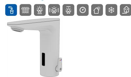
Berührungslose, elektronisch gesteuerte Einloch-Waschtischarmatur, drucklos, mit IR-Sensor, Hygienespülprogramm und Mischer mit einstellbarer Temperaturbegrenzung, Oberfläche verchromt, Betriebsdruck: 0,3 - 10 bar - max. 80°C. OHNE Stromversorgung
