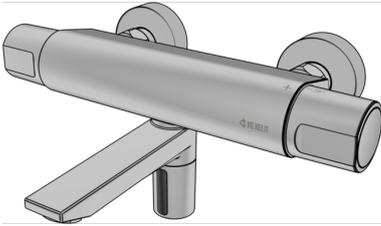
Berührungslose, elektronisch gesteuerte Aufputz-Wand-Waschtischarmatur, Hochdruck mit IR-Sensor und Thermostatmischer. Mit Temperatursperre max. 43°C, Umbau auf max. 38°C möglich. Thermische Spülung durch Entriegelung des Thermostats durchführbar. Oberfläche verchromt, Betriebsdruck: 0,3 - 10 bar - max. 80°C. Stichmaß 150mm, Anschluss 3/4" mit Flachdichtung, mit S-Anschlüsse G1/2" AG auf G3/4" AG, Ausladung 200mm. Batteriebetrieben. Angegeben ist die Länge der Ausladung.
