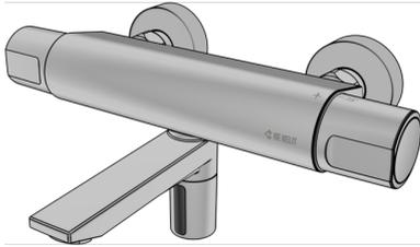
Berührungslose, elektronisch gesteuerte Aufputz-Wand-Waschtischarmatur, Hochdruck mit IR-Sensor und Thermostatmischer. Mit Temperatursperre max. 43°C, Umbau auf max. 38°C möglich. Thermische Spülung durch Entriegelung des Thermostats durchführbar. Oberfläche verchromt, Betriebsdruck: 0,3 - 10 bar - max. 80°C. Stichmaß 150mm, Anschluss 3/4" mit Flachdichtung, mit S-Anschlüsse G1/2" AG auf G3/4" AG, Ausladung 200mm. Batteriebetrieben. Angegeben ist die Länge der Ausladung.
