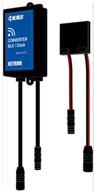
Zur Herstellung einer kabellosen Verbindung zwischen KETRON-Geräten und einem Smartphone oder Tablet. Funktionserweiterung: Kompatibilität zur KE KELIT KETRON Service App, vereinfachte Konfiguration von Parametern, Auslesen von Betriebsdaten, bedarfsgerechte Hygienespülung, Echtzeitfunktion, Erstellung von Protokollen mit Parametern, Betriebsdaten und Aufzeichnungen über Hygienespülungen. Zum Einstecken zwischen KETRON Stromversorgung und Gerät.
