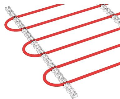
Oberflächennahes Kühl- und Heizdeckenmodul zur Montage auf der Deckenschalung. Bestehend aus, werkseitig vorgefertigte Rohrregister (PVC-frei), Rohrabstand 150mm aus ULTRA PE-RT Kunststoffrohren d16x2mm sauerstoffdicht gemäß ÖNORM EN 21003, vormontiert auf der KM610PP Klemmschiene. Das Brandverhalten einer Ortbetondecke mit integrierten oberflächennahen angeordneten Rohrregistern ist durch einen Brandversuch gemäß EN 1363-1/EN 1365-2 für die Feuerwiderstandsklasse REI 90 nachgewiesen
