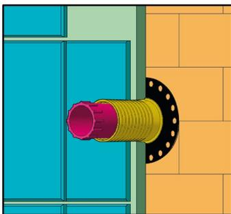
Die Dichtmanschette wird mit der flexiblen Membrane über die Wandscheibe geschoben und der Baustopfen eingeschraubt. In diesem Zustand kann die Druckprüfung der Rohrinstallation durchgeführt werden.
