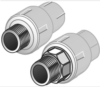
KELEN PP-RCT Polyfusions-Schweißformstück, Verbindung von Rohren und werkstoffgleichen Fittings ohne Querschnittsverengung, mit eingespritztem Außengewinde aus entzinkungsbeständigem Messing und porenfreier Metallisierung, Gewinde gemäß ÖNORM EN 10226
