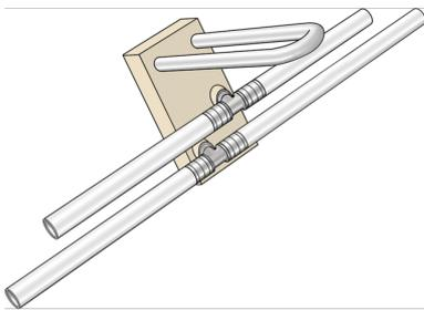
SL-Isolierwandeinbaublock für Ventil-Heizkörper, zur Montage im UP-Bereich vor den Verputzarbeiten, inkl. eingelegten KELOX Modulrohren zum beidseitigen Weiterführen in der Sockelleiste, zwischen VL und RL verbundenen CU-Rohren d15 mm porenfrei metallisiert, zum nachträglichen Anschließen der Heizkörper, VL-unten
