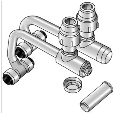
Steck SL-Radiator-Anschlussgarnitur aus Messing porenfrei metallisiert, geeignet für die Verarbeitung mit C-Stahl-, Edelstahl- und Kupferrohren, HK-Anschlussrohr d12x1mm, inkl. höhen- und tiefenverstellbarem Eck-Absperrventil, die längskraftschlüssige Rohrfixierung des Absperrventiles wird mit Sechskantschlüssel M13 an der Vorderseite vom Absperrventil sichergestellt, die Absperrung erfolgt mit Inbusschlüssel 4mm, Radiatoranschlüsse 3/4"IG flach dichtend
