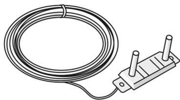
Zum Messen und Fühlen des Taupunktes bei Kühldeckenanlagen, die Montage erfolgt in der Kühldecke am Mediumrohr, die Schnüffelrohre werden nach der Montage der Decke abgeschnitten und messen die Luftfeuchte, inkl. 10m Kabel (2x0,5mm<sup>2</sup>) und Befestigungsmaterial zur Befestigung am Rohr.
