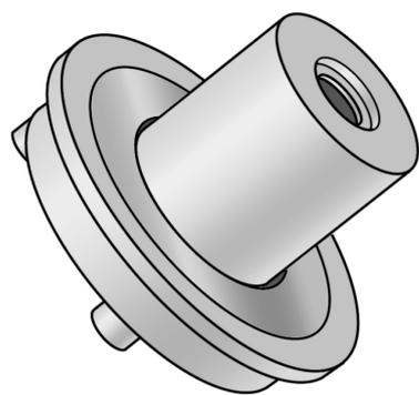
Ortungspunkt, als Betoneinlegebauteil mit integriertem Magneten auf einer Deckenschalung mit Edelstahlnägeln (in eigener Position) befestigt. Zur Fixierung und Auffindung von Referenzpunkten in Ortbetondecken und Wänden
