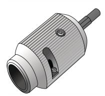
Zum Abschälen der KELIT Alu-Rohre im Schweißbereich, bei Verwendung von E-Schweißmuffen MUSS durch Lösen der Inbusschraube am Schälwerkzeug der Anschlag verlängert werden. Alternativ können langsam laufende Bohrmaschinen oder Akkuschrauber mit max. 500 U/min verwendet werden
