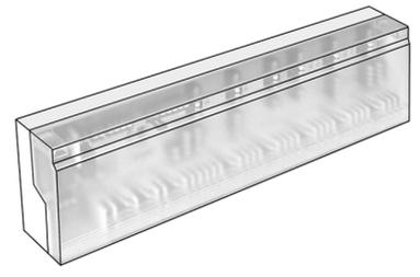
Zum Anschluss von max. 6 Raumthermostaten, Anschlussmöglichkeit für bis zu 15 Thermikmotoren, max. 5 Thermikmotoren pro Kanal, Anschlussmöglichkeit für eine Schaltuhr zur Zeitsteuerung bzw. Change Over-Signal, sowie einer Pumpenlogik zum Anschließen und Schalten einer Umwälzpumpe 230V / 200 Watt
